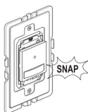
**REMARQUE : si vous avez besoin de retirer le détecteur après l'avoir enclenché dans le boîtier, ôtez d'abord le boîtier de la plaque murale pour accéder aux quatre ergots de verrouillage au dos du détecteur. Insérer un tournevis plat pour enfoncer les ergots en appliquant une pression afin de dégager le commutateur.**
