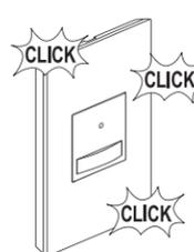
**REMARQUE – Si la plaque murale doit être retirée, insérer un tournevis à tête plate dans les rainures situées à l'arrière de la plaque et les tourner lentement.**
