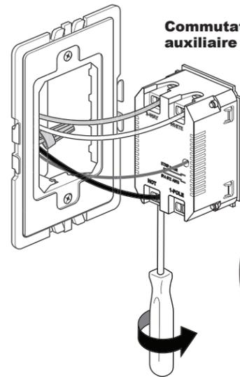
**AVERTISSEMENT : Ne pas associer des fils de section différente dans la même borne. Avec des fils de section différente, utiliser un capuchon de connexion pour ajouter un toron de 15 cm (6 pouces) du même calibre au fil de calibre plus petit.**
