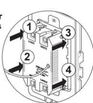
**6** Enclencher la plaque murale dans le boîtier. Il existe trois crans pour régler la position de la plaque murale sur le détecteur et le mur.
