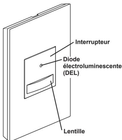
Le ASOS32 est conçu pour remplacer un commutateur standard unipolaire, multivoie ou pour ventilateur. Le détecteur utilise la technologie à infrarouge passif pour repérer les mouvements à l'intérieur d'un espace et allumer ou éteindre les lumières ou le ventilateur en fonction de la présence ou de l'absence de personnes. Ce dispositif est parfait pour une installation en intérieur où le détecteur donne directement sur la pièce.
