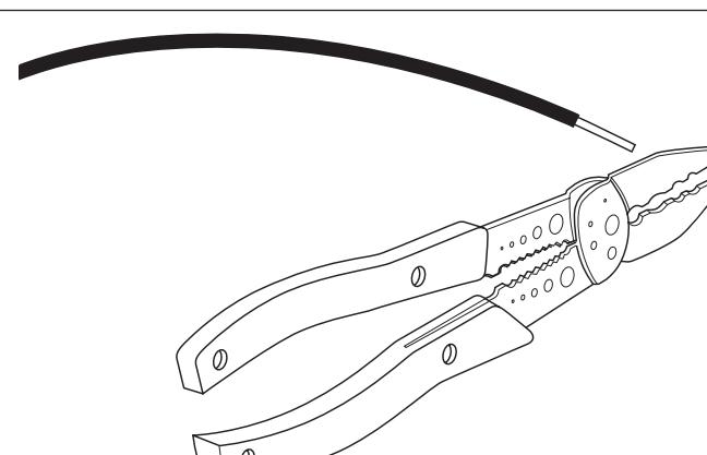
Si nécessaire, couper les fils et retirer la gaine d'isolation pour exposer 12,7 mm (1/2 pouce) de fil.
