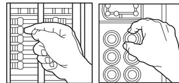
Luego, conecte la lámpara o radio en el otro enchufe del tomacorriente y enciéndala para verificar que no haya tensión en ninguno de los dos enchufes. Si hay tensión, detenga el trabajo y llame a un electricista para que complete la instalación.
