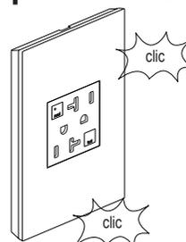
**NOTA:** para quitar la placa de pared, inserte un destornillador plano pequeño en las muescas de la placa de pared y gírelo suavemente para hacer palanca contra el marco.
