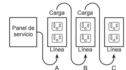
Colocar el interruptor diferencial en la posición A también protegerá a los tomacorrientes B y C "del lado de la carga". En cambio, colocar el interruptor diferencial en la posición C no brindará protección a los tomacorrientes A ni B. Recuerde que los tomacorrientes A, B y C pueden estar en habitaciones distintas.
