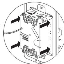
**NOTA:** si necesita quitar el tomacorriente luego de encastrarlo en el marco, primero quite el marco de la caja de pared para acceder a las cuatro lengüetas de sujeción en la parte posterior del tomacorriente. Inserte un destornillador plano para presionar las lengüetas a medida que aplica presión para empujar el tomacorriente hacia afuera.
