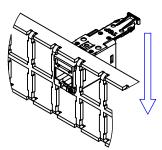
ONCE JACK SHOULDERS COME INTO CONTACT WITH BACKSIDE OF PANEL, PRESS DOWNWARD.
