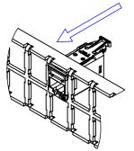
PUSH ON SLIDE LOCK UNTIL THE FRONT IS FLUSH WITH THE JACK FACE.
